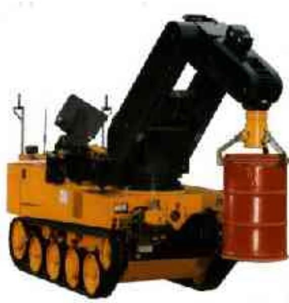
Abb.2 Roboter beseitigt dekontaminiertes Material
